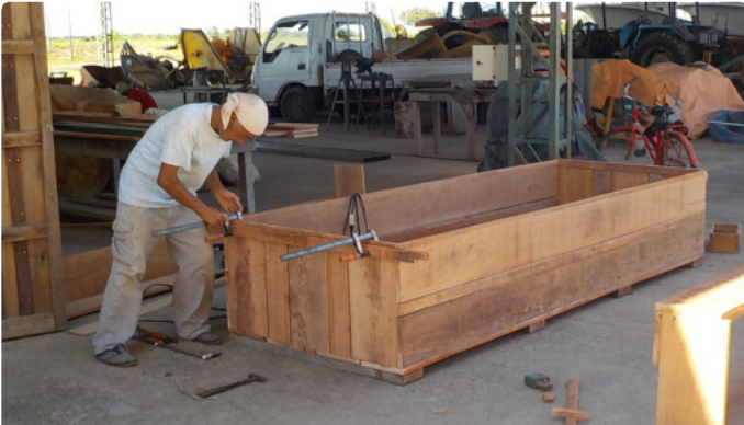
エビの養殖研究に使う水槽を製作。2018年5月14日
